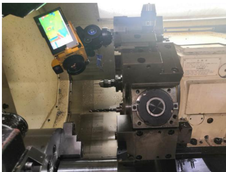
Рисунок 19 – Фото измерения температуры при резании заготовок на станке
