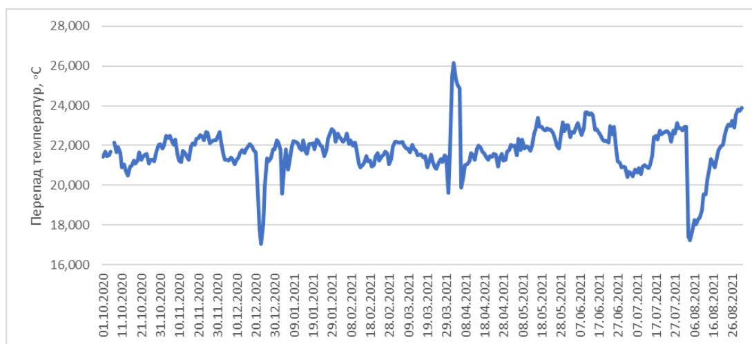
Рисунок 22 – Перепад температур между входом и выходом реактора
