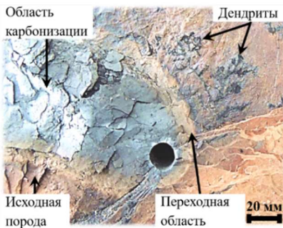
Рисунок 7 – Фотография образца после пробоя и частичной конверсии.
