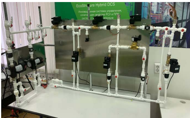
Рис. 4. Установка физического подоби для исследования сложных гидропневматических систем
