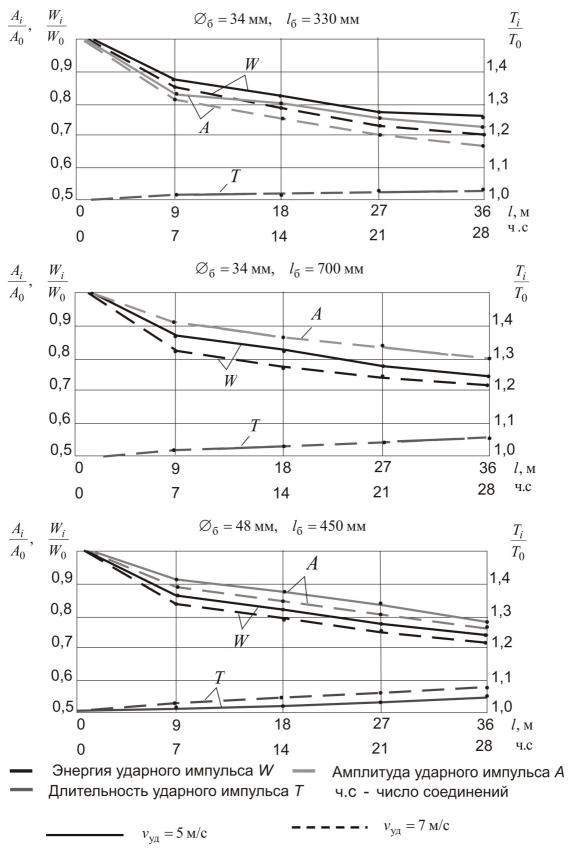
**Рис. 2.** Относительное изменение амплитуды A, энергии W, длительности T силового импульса в ставе штанг диаметром 33,5 мм с ниппелями, резьба  $K\Pi$  25×12;  $A_i$ ,  $W_i$ ,  $T_i$  и  $A_0$ ,  $W_0$ ,  $T_0$  — текущие и начальные значения параметров
