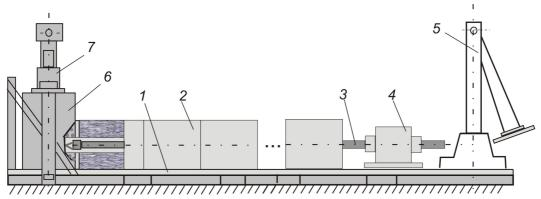
Рис. 1. Стенд для исследования передачи энергии ударных импульсов по ставу штанг
