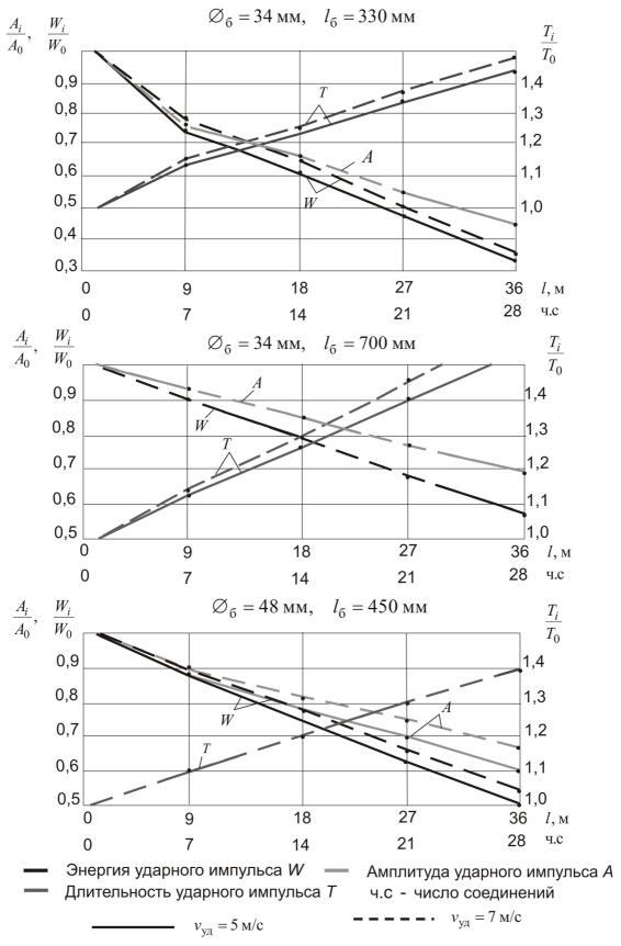
**Рис. 3.** Относительное изменение амплитуды А, энергии W, длительности T силового импульса в ставе штанг диаметром 40 мм с муфтами, резьба КП 38×12
