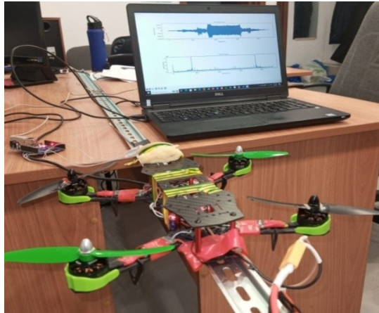
Рисунок 4.3 – Экспериментальная установка с датчиком, расположенном на платформе
