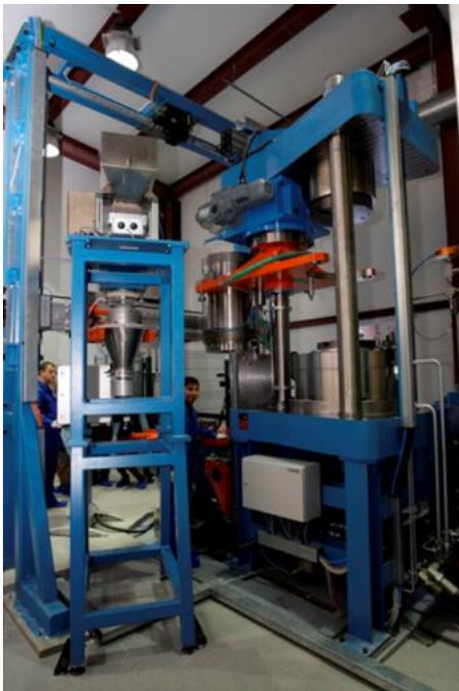
Рисунок Б.5 – Изостатический пресс «Frey»
