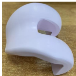
Рисунок 4.14 – Керамический феморальный компонент эндопротеза коленного сустава сложной конфигурации (опытный)
