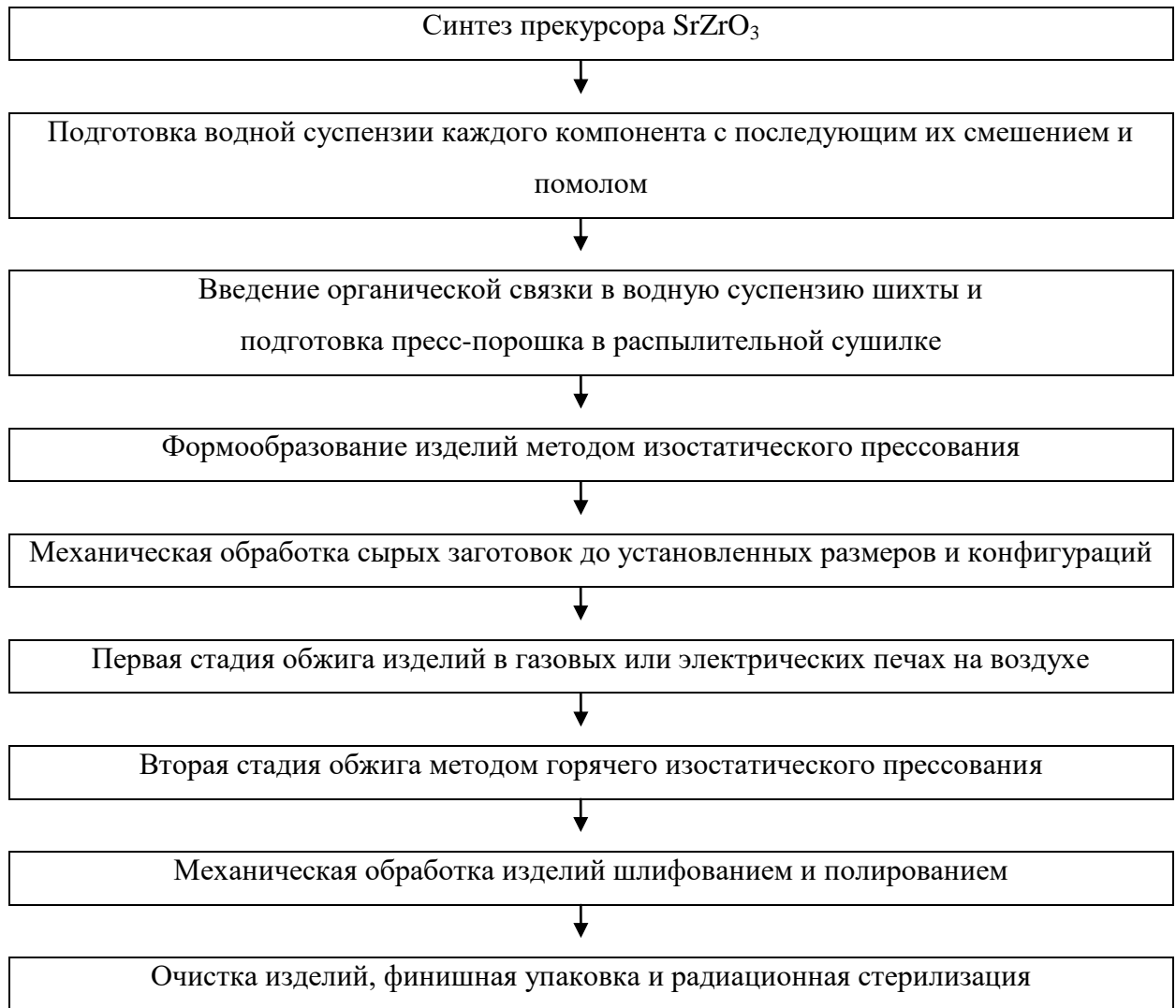
Рисунок 4.8 – Технологическая схема изготовления ортопедических изделий
