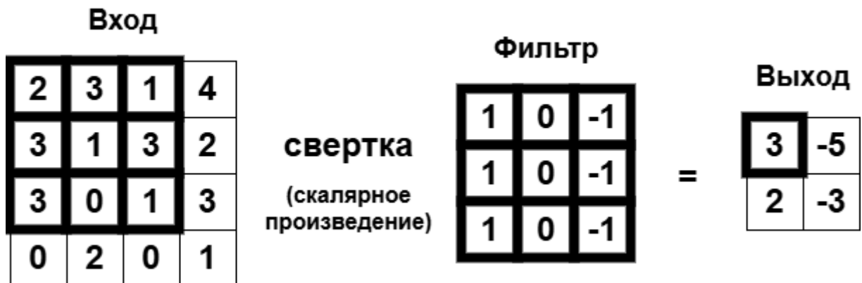
Рисунок. 2.1 – Принцип работы сверточного слоя
