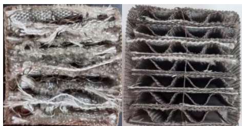
Рисунок 2.4 – Внешний вид экспериментальных картриджей с объёмной сеткой (слева) и с гофрированной и плоской металлической сеткой (справа).
