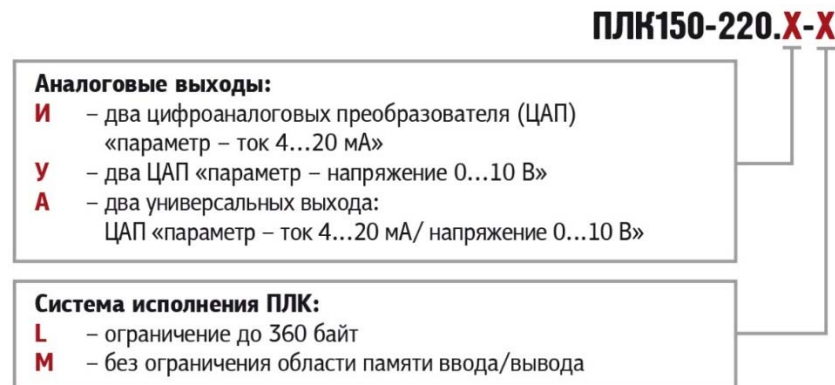
Рисунок 3.4 – Модельный ряд контроллеров ОВЕН ПЛК150-220
