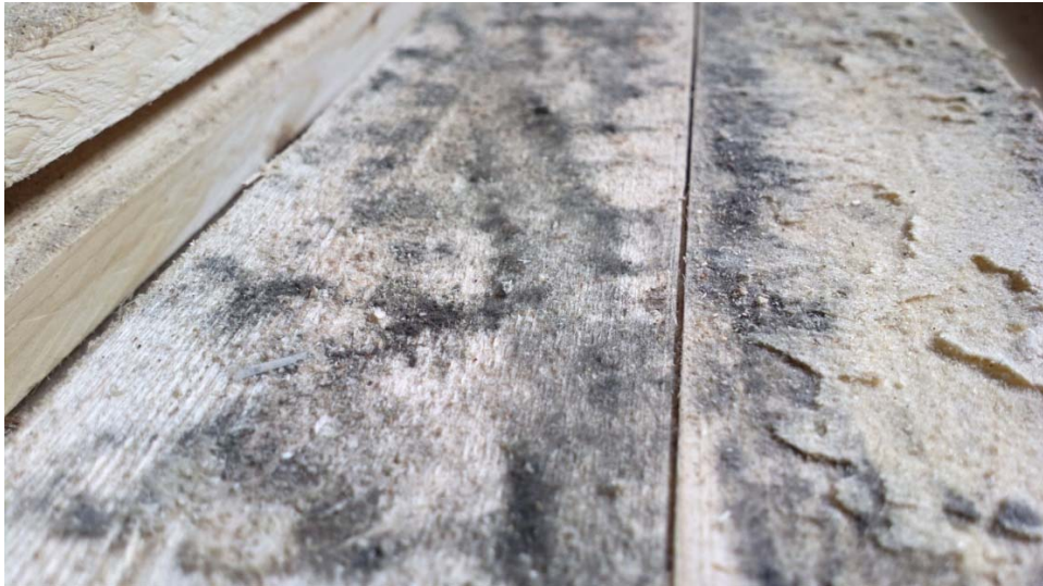
Рисунок 2.22 – Плесень на пиломатериале
