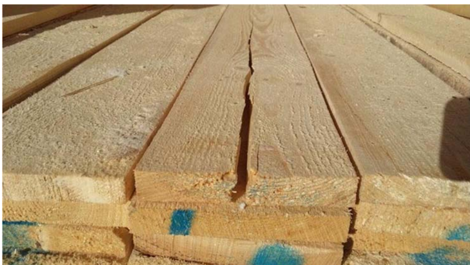
Рисунок 2.23 – Растрескивание сухой древесины
