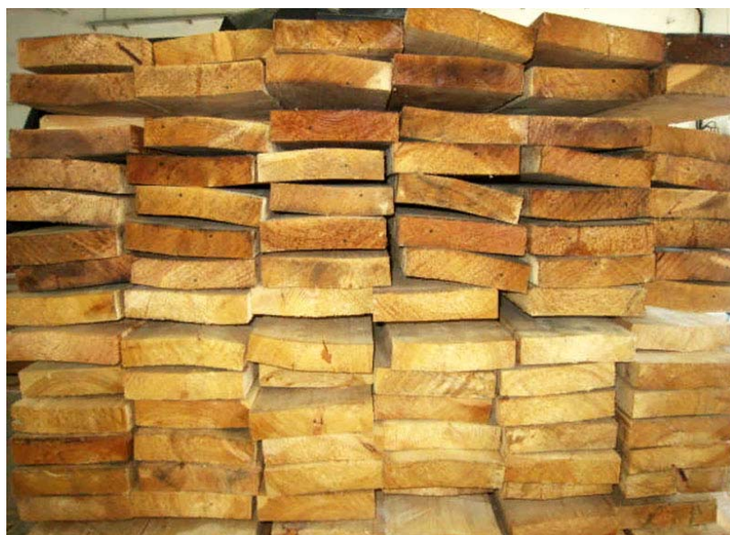
Рисунок 2.24 – Деформация сухого пиломатериала
