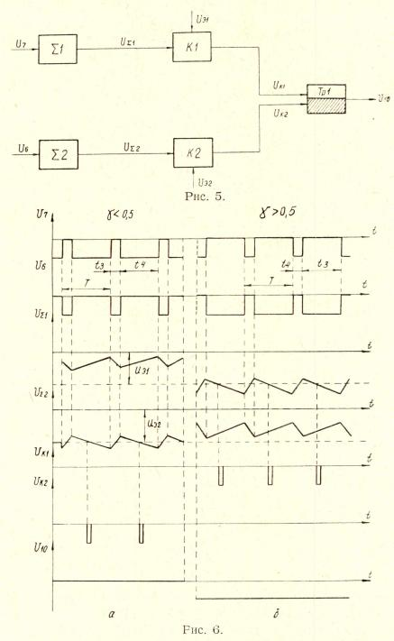
от относительной продолжительности включения  $\gamma$  будет генерировать один из компараторов, переводя тритгер Тр в соответствующее состояние. Триггер Тр в свою очередь управляет работой переключающего устройства ПУ, изменяющего структуру системы.
