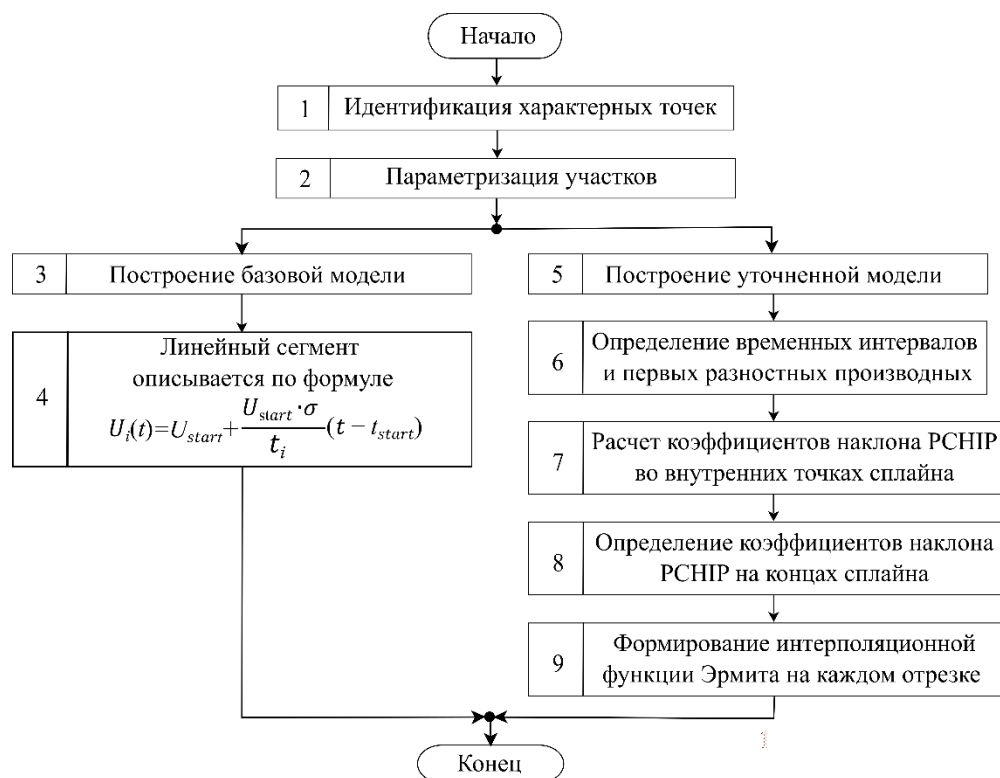
Рисунок 4.5 – Алгоритм построения обеих моделей напряжения в предаварийном состоянии
