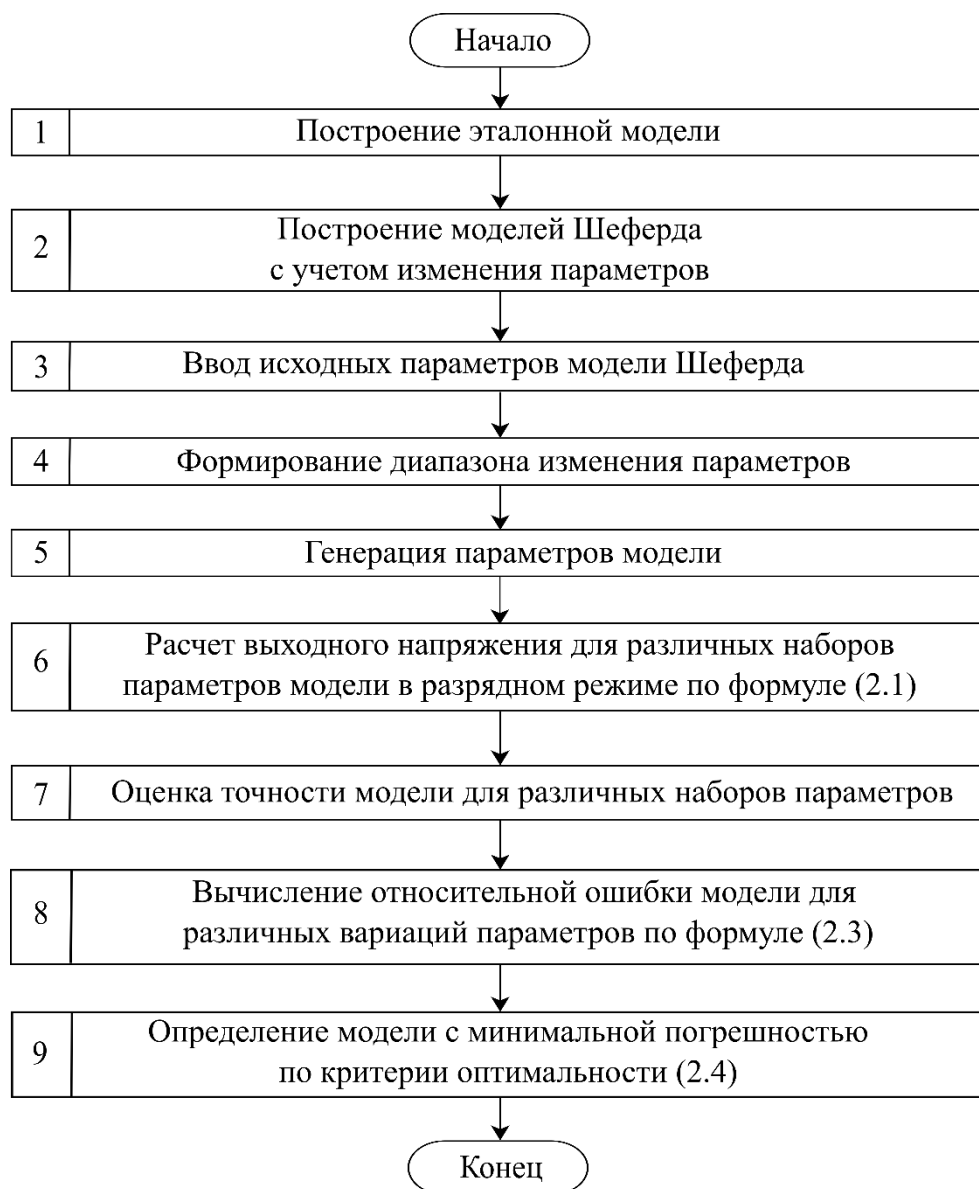
Рисунок 2.5 – Блок-схема алгоритма повышения адекватности модели Шеферда ЛИА
