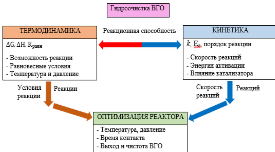
Рисунок 55 – Этапы моделирования процесса гидроочистки вакуумного дистилята
