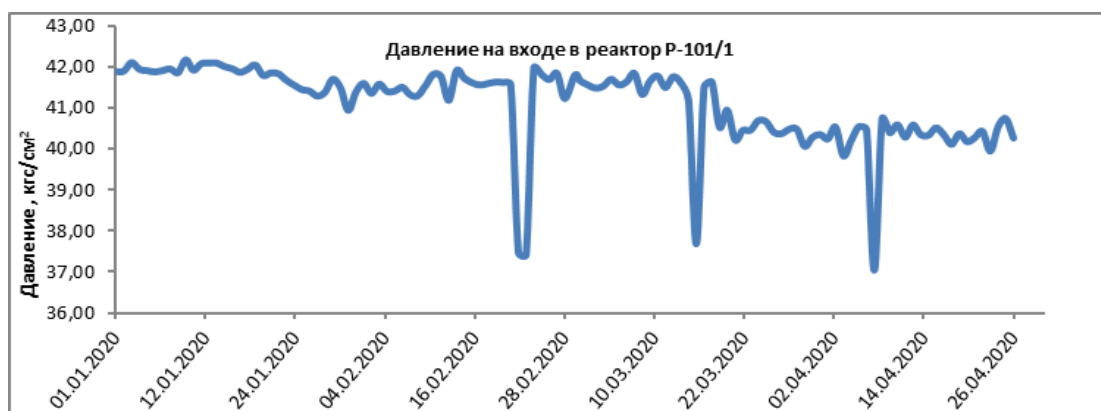
Рисунок 46 – Динамика давления на входе в реактор
