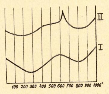
Рис. 1. Кривые нагревания скаполита (I) и скаполитита (II).
