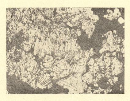
Рис. 2. Характер зональности в агрегатах пирита. Полированный шлиф. Протравлено. Увел. 270.
