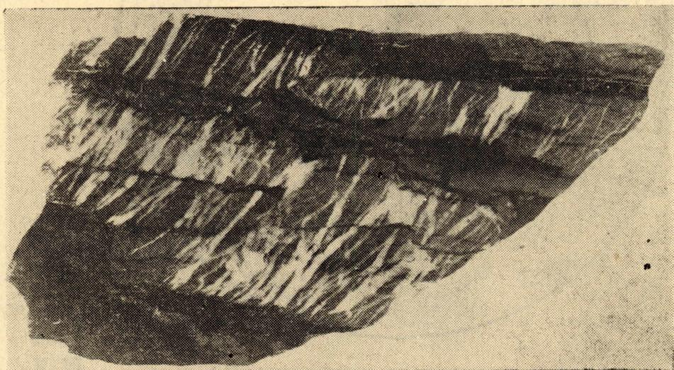
Рис. 3. Трещинки поперечного отрыва в слоях песчаников, залеченные кварц-карбонатным материалом. Полированный штуф. Натуральная величина
