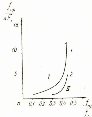
Рис. 3. К понижению чувствительности при неудачном выборе  $f_2$ . 1 — кривая, соответствующая значению  $\frac{P_{\Sigma}''}{P_0} = 1,1$ ;
