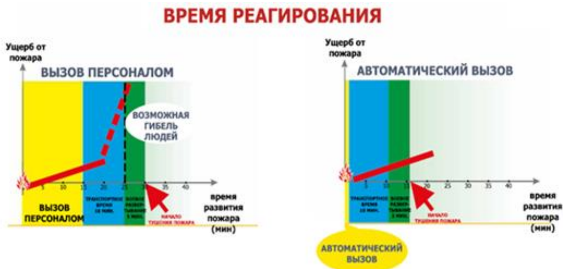
Рис.1. Время передачи сигнала в пожарную службу
