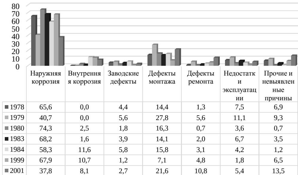
Рис. 3 – Отказы трубопроводов по причинам возникновения (в %)
