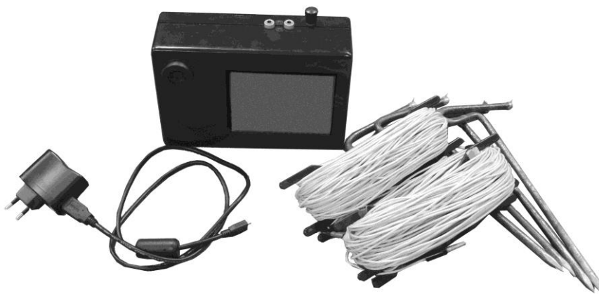
Рис. 3. Внешний вид измерителя сопротивления заземления опор ЛЭП
