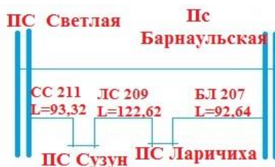
Рис.1. Участок Алтайской энергосистемы
