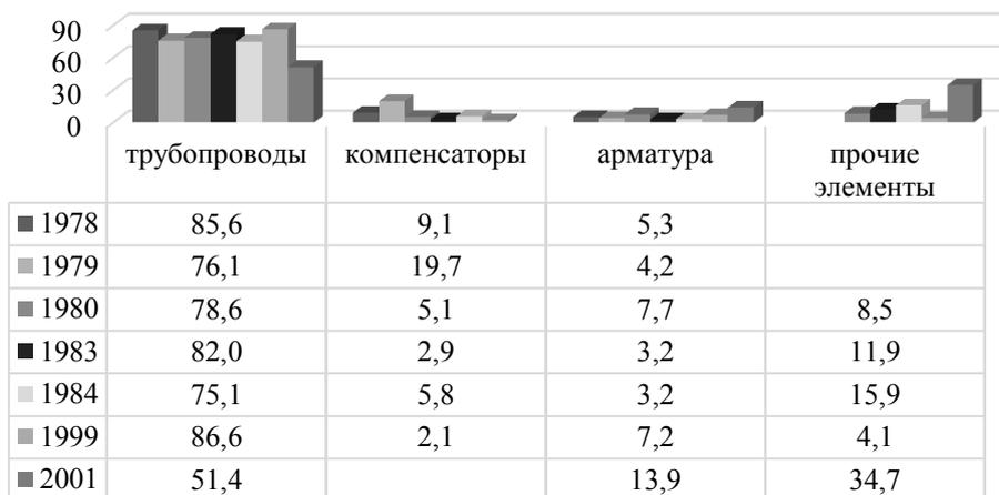
Рис. 2 – Отказы тепловых сетей по элементам возникновения (в %)
