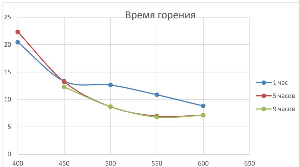
Рис. 3 – Зависимость времени горения ВУТ от температуры и выдержки помола
