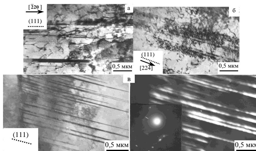
**Рис. 3.** Этапы формирования двойников деформации: а) однослойные, б) многослойные дефекты упаковки (незавершенное двойникование) и в) микродвойники (завершенное двойникование): а– $\varepsilon = 5\%$ ; б– $\varepsilon = 8\%$ ; в– $\varepsilon = 14\%$ . Пунктирными линиями отмечен след габитусной плоскости (111)
