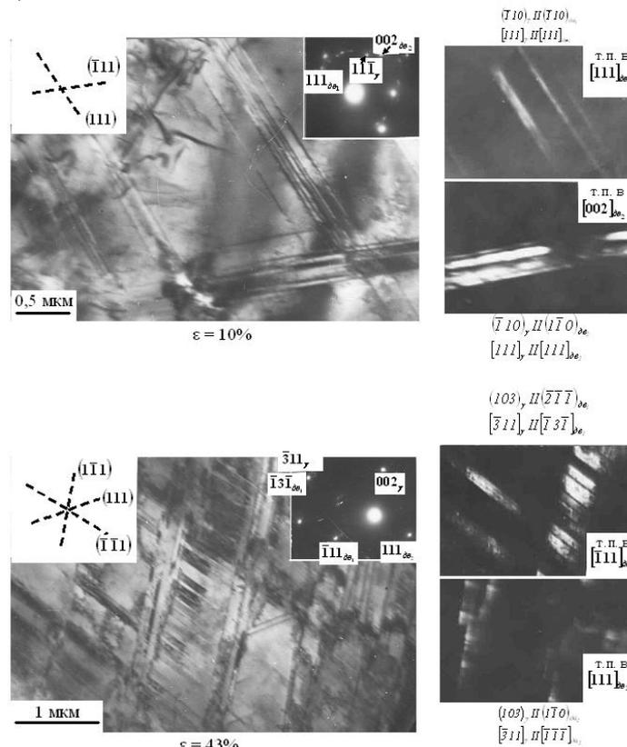
**Рис. 5.** Пересекающиеся системы микродвойников в стали 110Г13
