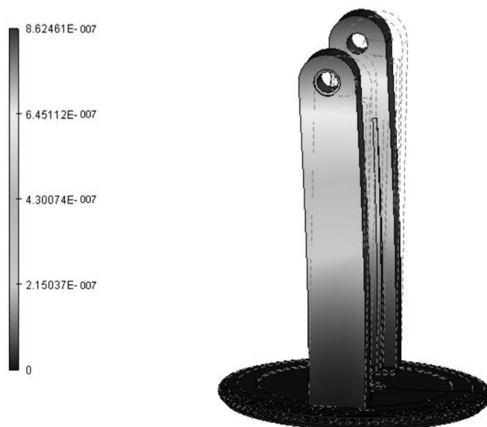
Рис. 5. Перемещение стоек под нагрузкой
