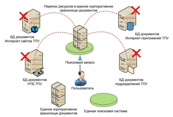
**Рис. 2.** Архитектура системы поиска с использованием централизованного массива информации
