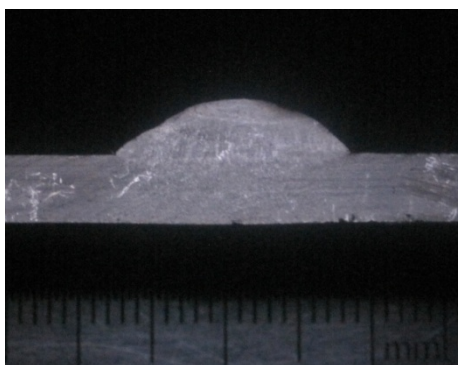
Рис. 5. Наплавка расщеплённым электродом
