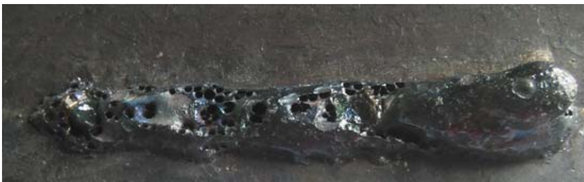
Рис. 3. Качество поверхности сварного шва при сварке с использованием фракции 5 – 10 мм
