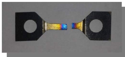
Рис. 1. Внешний вид исходного образца после растяжения (длина 4 см)
