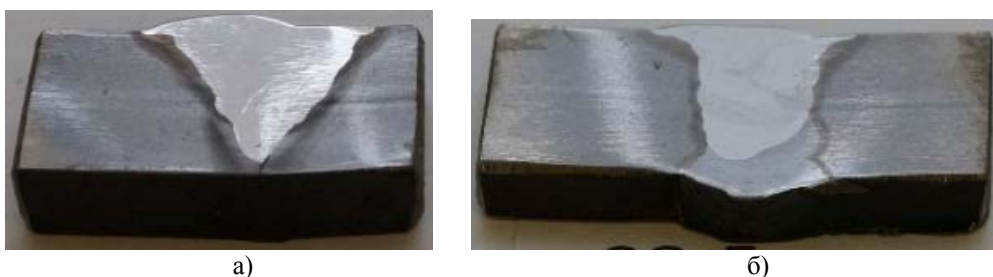
Рис. 3. Макрошлифы сварных соединений при двухдуговой сварки с расстоянием между дугами 100 мм: а) угол скоса кромок 30 градусов; б) угол скоса кромок 6 градусов
