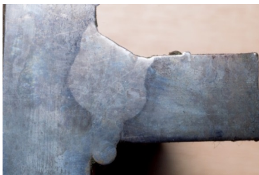
Рис. 2. Шлиф корневого шва таврового соединения толщиной 12 мм
