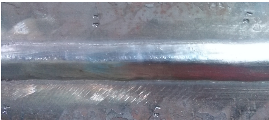
Рис. 1. Качество поверхности сварного шва при сварке с использованием фракции 0,45–2,5 мм
