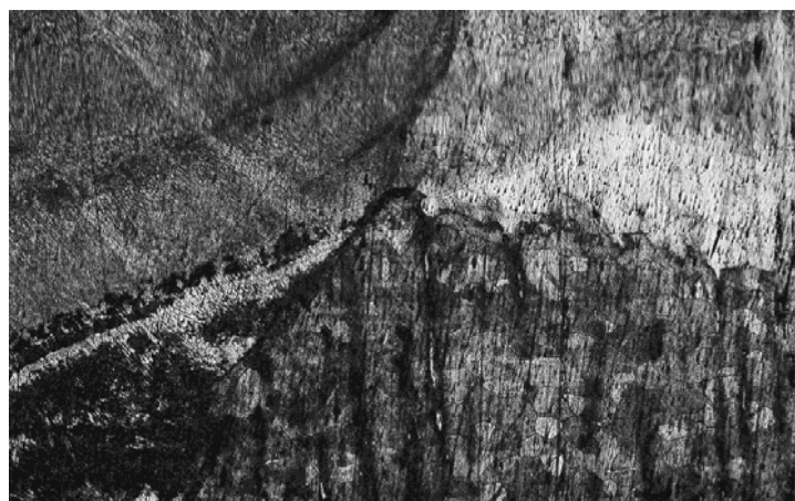
Рис. 8. Микроструктура зоны сплавления
