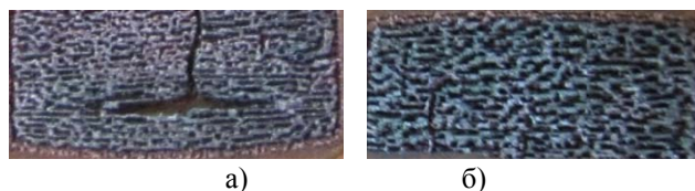
Рис. 2. Внешний вид спеченной поверхности ПМС-1 (x2). Режимы СЛС P=15 Вт, V=200 мм/мин, S=0,3 мм, t=200^{\circ}\text{C} : а– на воздухе; б– в аргоне
