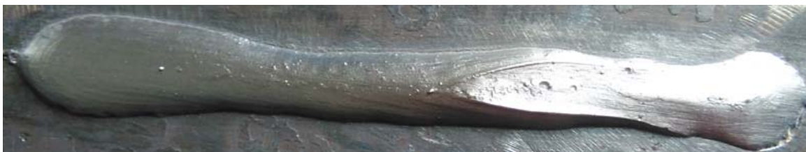
Рис. 4. Качество поверхности сварного шва при сварке с использованием фракции менее 0,45 мм
