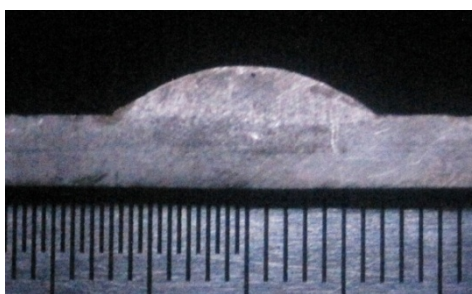
Рис. 4. Наплавка одним электродом обратной полярности
