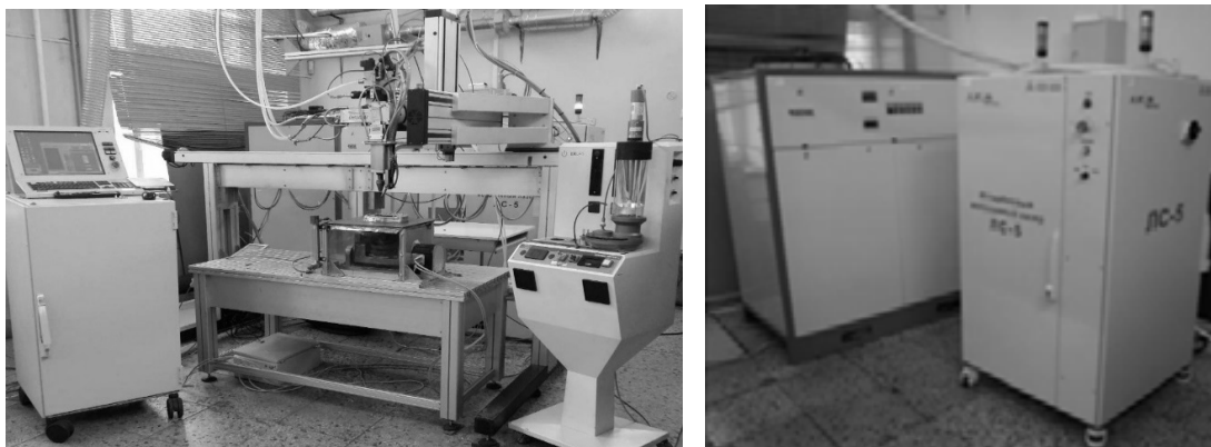
Рис. 1. Изображение экспериментального стенда для исследования технологического процесса высокоскоростного прямого лазерного выращивания изделий на базе лазера ЛС-5
