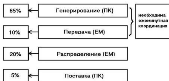
Рис. 1. Стадии производства электроэнергии [2, с. 19]
