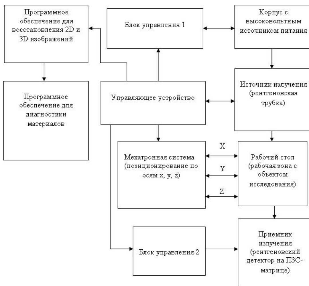
Рис. 1. Обобщенная схема рентгеновского микротомографа
