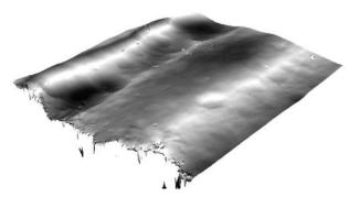
Рис. 5. Фрагмент поверхности титана, предварительно обработанного ультразвуком; New View,  $N_p{\sim}2{\times}10^6$  циклов,  ${\times}600$ .
