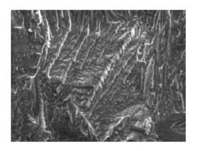
Рис. 3. Ті- $H_2$ . Фрактограмма усталостного разрушения, РЭМ,  $\times 800$ .
