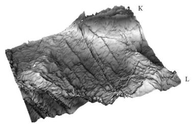
Рис.4. Ті- $H_2$ . Объемное изображение поверхностного слоя вблизи магистральной трещины KL, New View,  $\times 1300$ .
