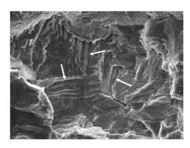
Рис. 2. Ті ВТ1-0. Фрактограмма усталостного разрушения при распространении магистральной трещины поперечных сдвигов, РЭМ, ×1300.
