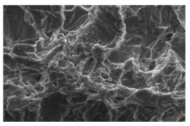
Рис. 6. Фрактограмма усталостного разрушения титана, обработанного ультразвуком,  $N_p \sim 2 \times 10^6 \mu$ ., ×1300.
