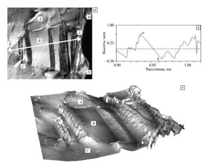
Рис. 1. Ті ВТ1-0. Характер гофрирования зерна В поверхностного слоя при раскрытии магистральной трещины MN: оптическое изображение  $\times$ 700 (a), профиль гофрирования вдоль KL ( $\delta$ ), объемное изображение гофрированного зерна В  $\times$ 1300 (a), New View.
