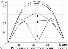
Рис. 1. Радиальное распределение осевой проекции скорости газового пока по сечениям вдоль потока: 1-0 мм; 2-55 мм; 3-215 мм; 4-375 мм; 5-540 мм.
