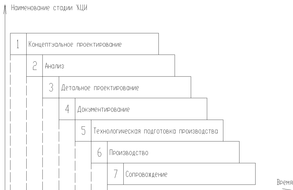
Рис. 1. Организация ЖЦПО на основе концепции «параллельного» проектирования (С-технологии)
