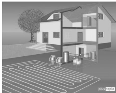
Рис. 2. Горизонтальный внешний контур теплового насоса жилого дома
