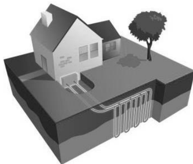
Рис. 3. Внешний контур теплового насоса вертикального типа
