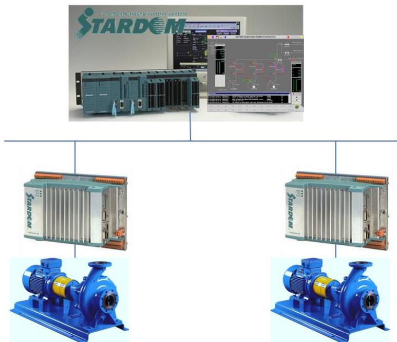
Рис. 2. Схема управления насосными агрегатами в составе управляющего комплекса Stardom FCJ «Yocogawa Electric»
