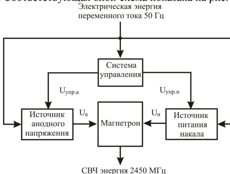
Рис.1. Блок–схема СВЧ генератора магнетронного типа
