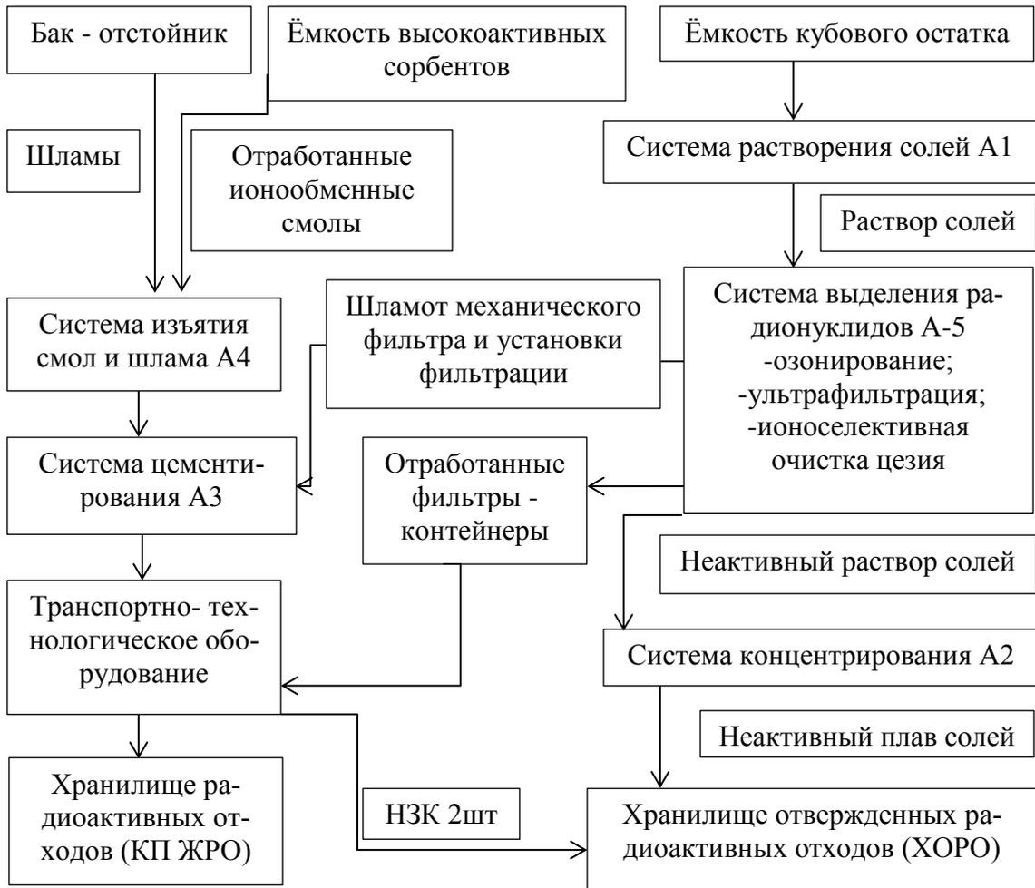
Рис. 1. Принципиальная схема переработки ЖРО на КАЭС
