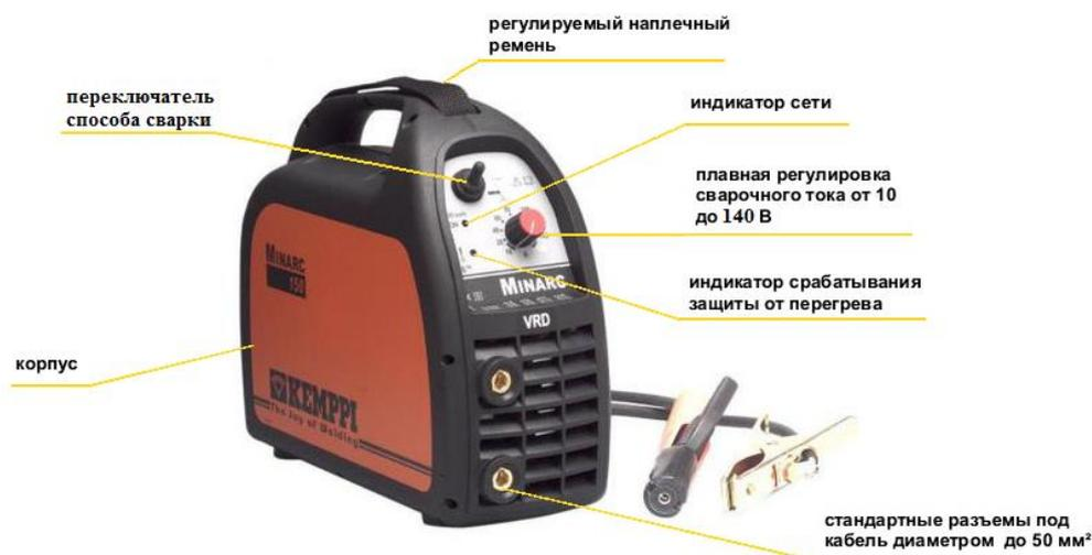
Рис. 1. Устройство инверторного сварочного аппарата
