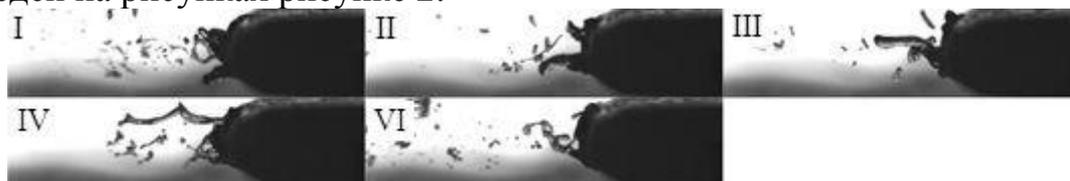
Рис. 2. Кинограмма процесса схода пленки с лопатки со скругленной кромкой. Интервал между кадрами  $1,068 \cdot 10^{-4}$  с.
