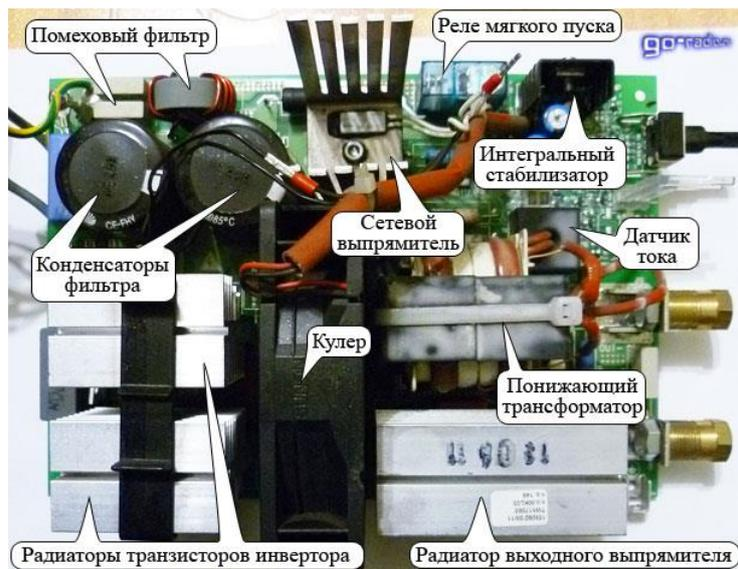
Рис. 2. Внутреннее устройство сварочного инвертора
