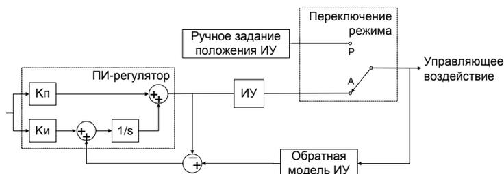
Рис. 6. Пересчет И-составляющей для ручного управления ИУ
