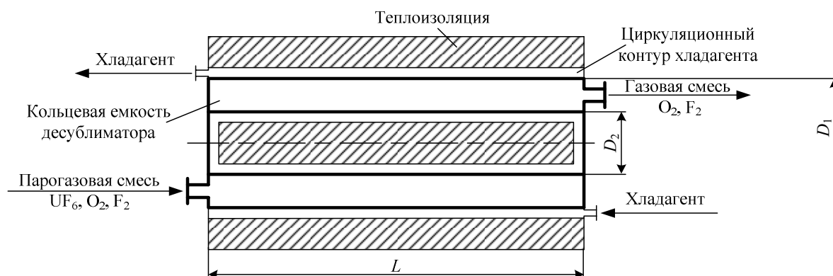
Рис. 1. Схема потоков, поступающих в десублиматор и выходящих из него. L – длина кольцевой емкости десублиматора; D_1 , D_2 – диаметры внешнего и внутреннего кольца аппарата
