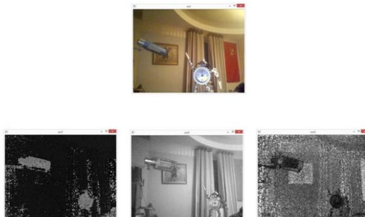
Рисунок 1 - Разделение изображения на каналы
