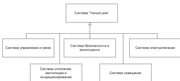
Рис. 1. Состав системы “умный дом”
