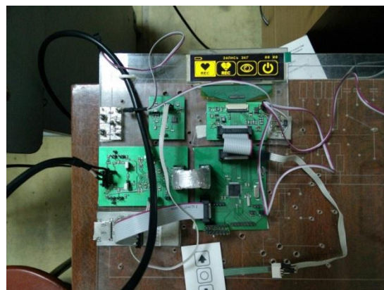
Рис. 4. Макет для экспериментов с биоимпедансом
