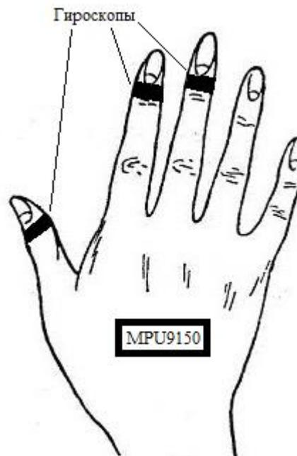
Рис. 1. Схематичное расположение датчиков на руке пользователя
