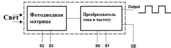
Рис. 2. Функциональная схема датчика TCS230
