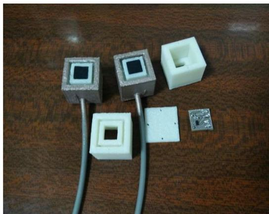
Рис. 2. Улучшенные «сухие» электроды
