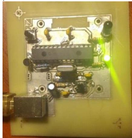
Рис. 3. Внешний вид устройства измерения силы света
