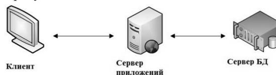
Рис. 1. Трёхуровневая архитектура системы оповещения
