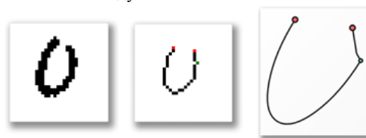
Рисунок 3 - Пример необходимости в использовании эллиптической дуги
