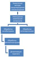
Рис. 2. Химические методы предотвращения самовозгорания
