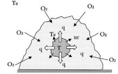
Рис. 1. Схема возникновения «горячей точки»
