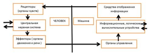
Рис. 1.1. Структурная схема системы "человек — машина"
