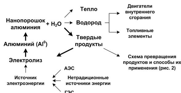
Рис. 5. Схема энергетического цикла:  $НП Al + H_2O \rightarrow H_2 + \text{твердые продукты} \rightarrow \text{электролиз} \rightarrow \text{диспергирование } Al \rightarrow НП Al$
