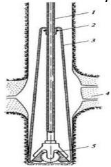
Рис. 3. Оболочка для перекрытия поглощения в процессе бурения скважины: 1- бурильная колонна, 2 – зажим, 3 – водонепроницаемая оболочка, 4 – поглощающий пласт, 5 – долото
