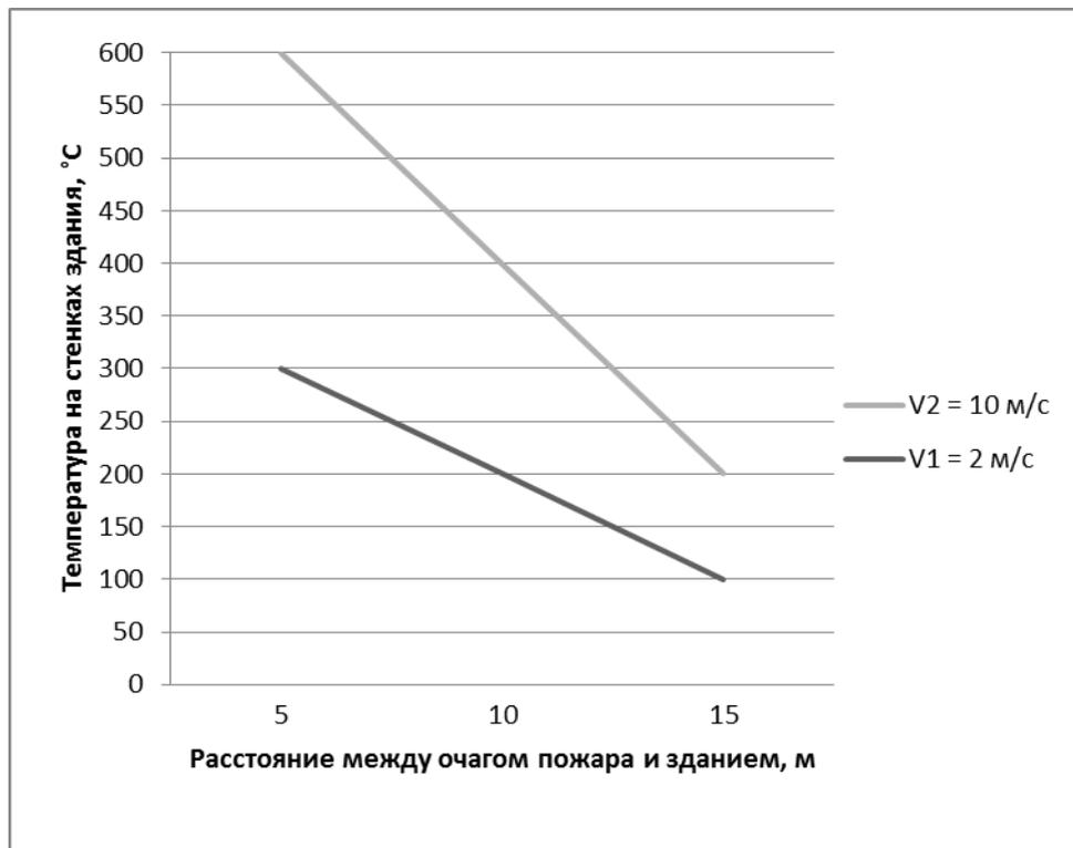
Рис. 3. Зависимость температуры на стенках деревянного строения для различных скоростях ветра (линии 1 и 2 соответственно при скоростях 2 и 10 м/с) на расстоянии 10 м от очага пожара
