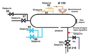
Рис. 1. Технологическая схема отстойника после аварии
