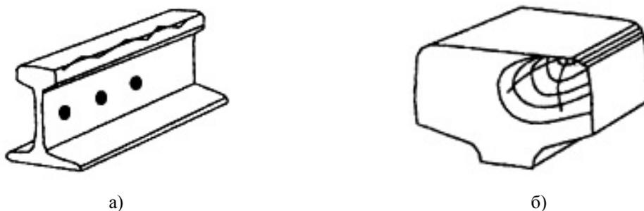
Рис. 2. Схема образования контактно-усталостных дефектов железнодорожных рельсов:
