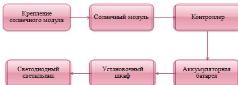
Рис. 1. Схема автономного светового устройства на солнечных батареях
