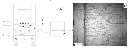
Рис. 1. Схема твердомера Виккерса КВ 30SPruftechnikGmbH (a):1 – компьютер со специальным программным обеспечением; 2 – кнопка включения питания; 3 – столик; 4 – 20Х объектив; 5 – индентор (алмазная пирамидка); 6 – обзорная камера и снимок профиля поперечного шлифа образца циркониевого сплава Э110 после наводороживания(б)
