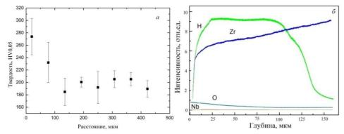
Рис. 2.Результаты измерения микротвердости поперечного шлифа (a) и профиль распределения водорода по глубине наводороженного образца циркониевого сплава Э110 (б)
