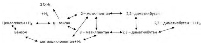
Рис. 1. Модельная схема превращения гексана на цеолитах
