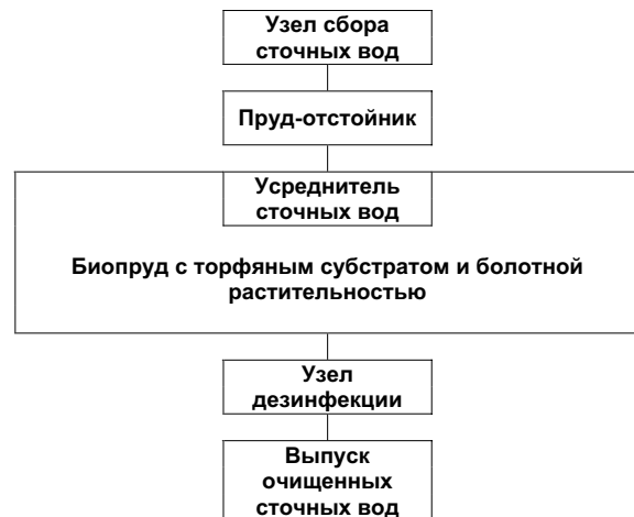
Рис. 1. Типовая схема очистки хозяйственно-бытовых сточных вод с использованием мелководного биопруда с торфяным субстратом и болотной растительностью
