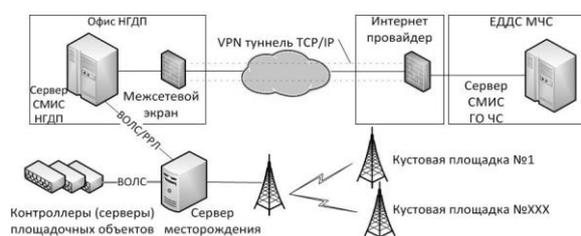
Рис. 1. Типовая схема организации связи НГДП
