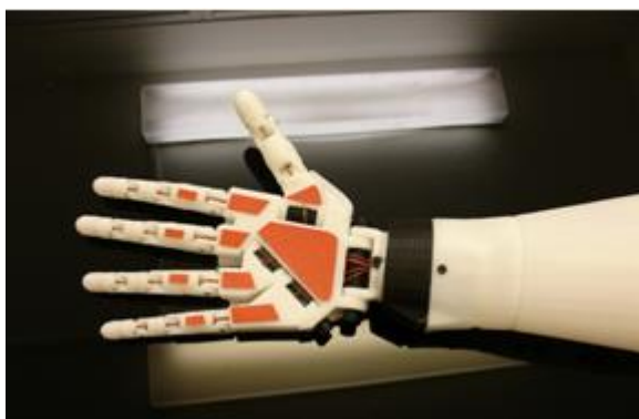
Рис.1. Антропоморфный захват InMoov
